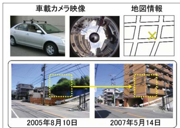
車載カメラ映像による建物変化の自動検出 Automatic Detection of Urban Scenery Change using Car-Cameras
