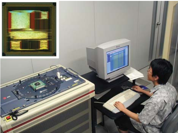
試作 LSI チップの動作試験 Operation Test of the Experimental LSI Chip
