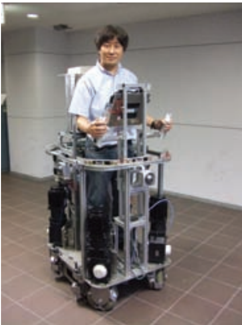
全方向に移動できる個人用知的移動体のプロトタイプ Personal Intelligent Vehicle Capable of Omni-Directional Movement
